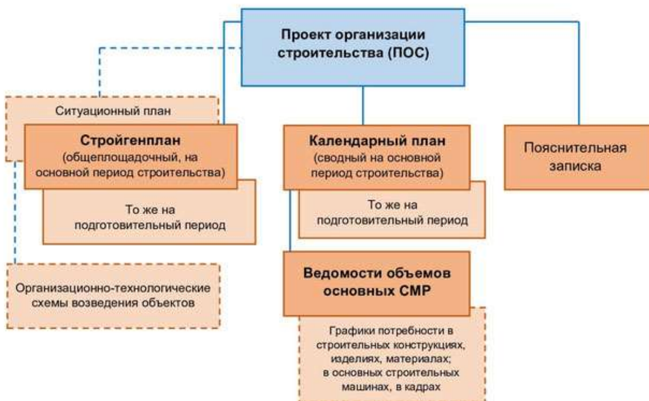
Рис.29 Производственный инжиниринг начинается с ПОС и организации работ на стройплощадке
